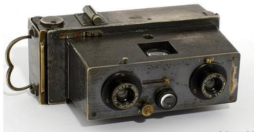
Deux vérascoptes de Richard, appareil stéréoscopique construit en 1893. 32000 furent construit jusqu'en 1913. Il utilisait des plaques en verre de 45 x 107mm (voir la vitrine).
